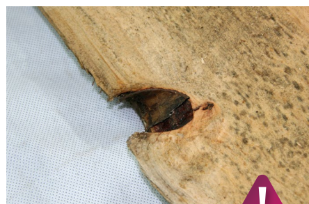
Vylomené hrany – přípustné do 10 mm
