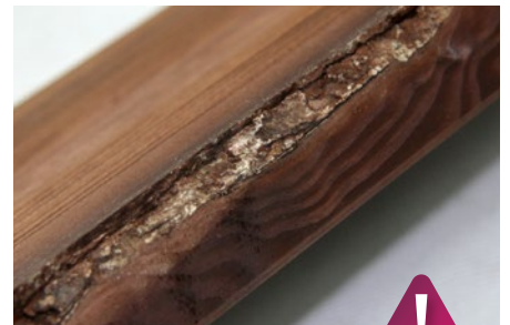
Kantenausbruchäste - kleine auf der Rückseite erlaubt
