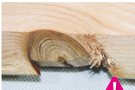
Élhány a széleken – 20 mm átmérőig megengedettek
