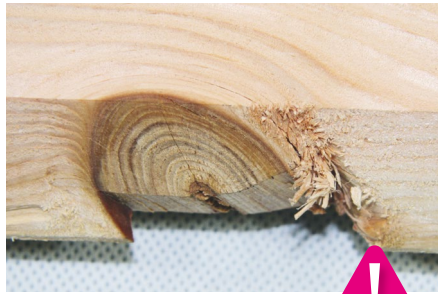
Kantenausbrüche - zulässig bis 20 mm, maximal 2 Stück pro lfm
