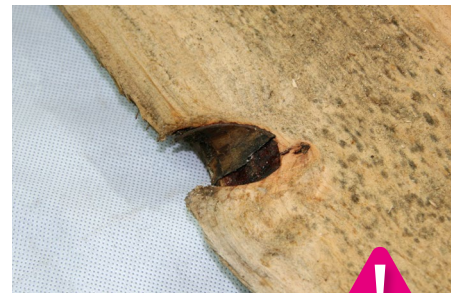
Kantenausbruch - bis 10 mm zulässig
