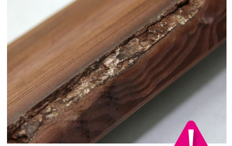
Nodi nelle scheggiature sui bordi - piccoli nodi sono consentiti sul lato posteriore
