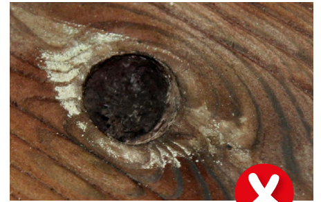
Nodi cadenti - non ammessi a partire da 10 mm
