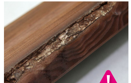
Kantenausbruchäste - kleine auf der Rückseite erlaubt
