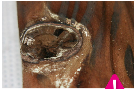
Fori di nodo - ammessi sporadicamente fino al 20 %
