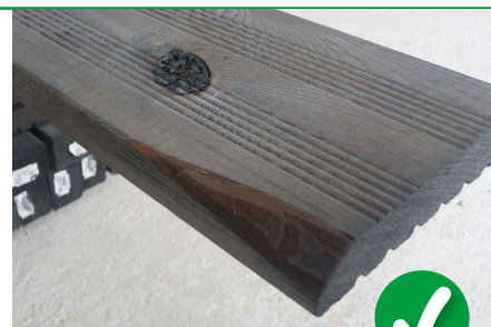
Vypadnuté hrče – neprípustné od 10 mm
