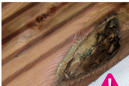
Okrajové výlomy – prípustné do 20 mm, maximálne 2 kusy na bežný meter
