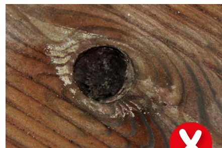
Vypadnuté hrče – neprípustné od 10 mm
