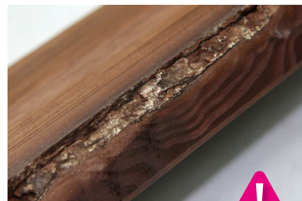
Okrajové výlomové hrče – prípustné malé na zadnej strane
