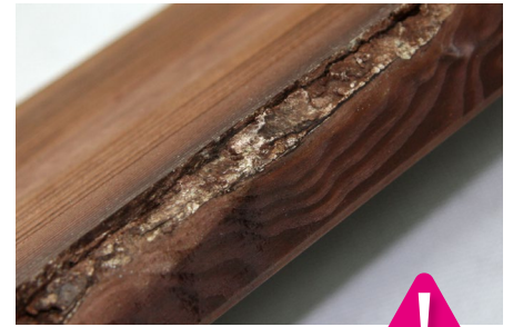
Kantenausbruchäste - kleine auf der Rückseite erlaubt
